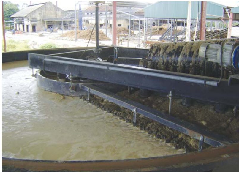
Công ty CP Giấy Sông Lam tái sử dụng toàn bộ nước thải, thu hồi được lượng bột giấy trong nước thải.
