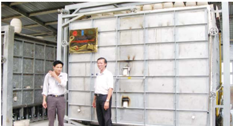
Lò gas nung gốm tiết kiệm năng lượng áp dụng tại Công ty gốm sứ Bát Tràng.
