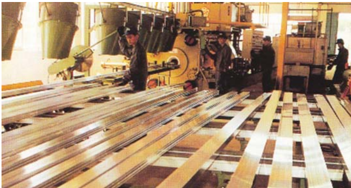
Sản phẩm nhôm thanh định hình sau máy cán ép trong dây chuyền sản xuất nhôm thanh của Công ty CP Nhôm Sông Hồng.
