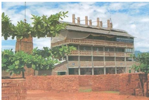
Lò gạch liên tục kiểu đứng đạt công suất cao, giảm ô nhiễm môi trường so với lò gạch thủ công.
