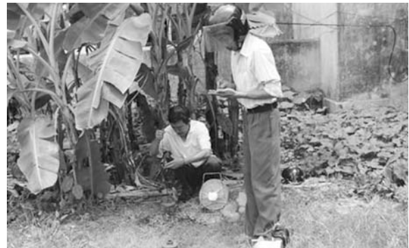
Đo nhiệt độ trong giếng khoan ở ngoại vi Hà Nội.
